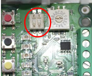
Figur 13: DIP switch DP1 og DP2
